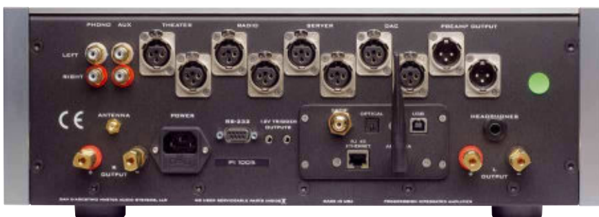
Reichlich Kontaktmöglichkeiten: 6 analoge Eingänge, Pre-Outs für Subwoofer und alle digitalen Schnittstellen sind vorhanden
